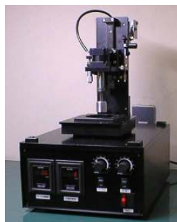
研磨装置3D-MNPS1(FDK製)の構造と概観
